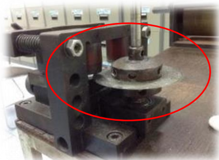
ภาพที่ 4 ใบมีดตัดที่ล็อกด้วยแป้นเกลียวของอุปกรณ์ตัดกันกระป๋อง
