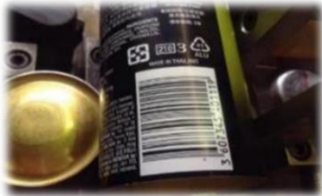
ภาพที่ 15 หลังจากเปลี่ยนใช้โรลเลอร์ที่ทำมาจากโพลียูรีเทนแล้วทำการทดสอบตัดกันกระป๋องแล้ว พบว่ามีรอยตัดเรียบ ไม่บวม ไม่มีรอยตำหนิบนผิวกระป๋อง
