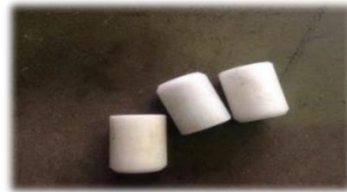
ภาพที่ 11 ลักษณะโรลเลอร์ที่ทำมาจากพลาสติก (POM)
