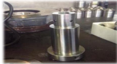
ภาพที่ 10 เพล่าขับใบมีดตัดที่นำมาลดขนาดความยาวใหม่
