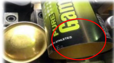
ภาพที่ 17 กระป๋องที่ทดสอบการตัดกันครั้งที่ 2 พบว่าที่ผนังกระป๋องไม่มีรอยบวมและไม่มีรอยตำหนิบนผนังกระป๋อง
