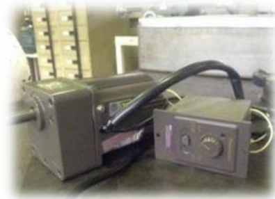
ภาพที่ 5 มอเตอร์ขับเคลื่อนกำลังหมุนชุดใบมีดตัด และชุดปรับความเร็วรอบ
