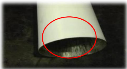
ภาพที่ 16 การทดสอบครั้งที่ 2 รอยตัดที่ผนังของกระป๋องเรียบสวยงาม ไม่เป็นครีบ เนื่องจากใบมีดตัดมีการหมุนที่เสถียรขึ้นมีรอยการตัดบรรจบพอดี
