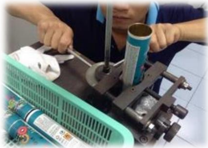
ภาพที่ 3 การปรับตั้งระยะใบมีดของอุปกรณ์ตัดกันกระป๋อง โดยใช้แท่งเหล็ก 2 แท่ง สอดใส่เข้าไปในรูเจาะของแป้นเกลียว แล้วหมุนทิศทางสวนกันเพื่อคลายแป้นเกลียวออก
