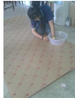
รูปที่ 2 วัดก้นกะละมังกับแผ่นอะคริลิกและตัดตามรอยที่วาดไว้
